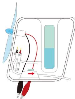
パージバルブと燃料電池がしっかりとチューブで繋がれていること、そしてパージバルブのスイッチが右側(溶液タンク寄り)にあることを確認してください。
