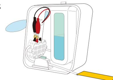
**手順3:** 今度は新しいpH試験紙をエタノール容器内の溶液に浸けてみます。pH試験紙の色がほとんど変わらないのを確認してください。
