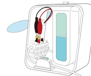
ワニグチグリップを外した状態で5~10分放置し、その後ワニグチグリップを接続するとファンは自動的に回転します。パージを一度行うことに5~10分間放置してください。化学反応はゆっくり進むので、パージなしでファンは15~17分間動作します。(実験3参照)
